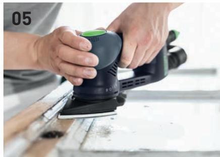
Für feineren Abtrag ROTEX RO 90 auf FEIN stellen und Granat Schleifmittel P100-P180 verwenden. Schleifen von Ecken oder schmalen Falzen mit dem ROTEX und Delta-Schuh hierzu Schleifmittel Granat P 60-P120 verwenden.
